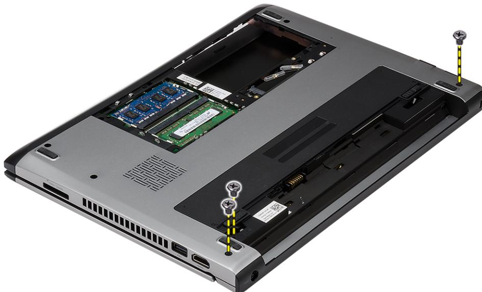
4. Girare il computer. Scollegare il cavo WLAN ed estrarlo dal canale di instradamento posto sul fondo del telaio.
